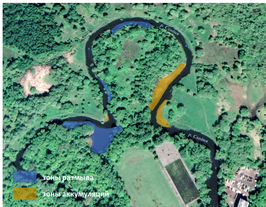
Рис. 2.3.2 Схема развития зон размыва и аккумуляций на примере меандра на р. Сходне.
